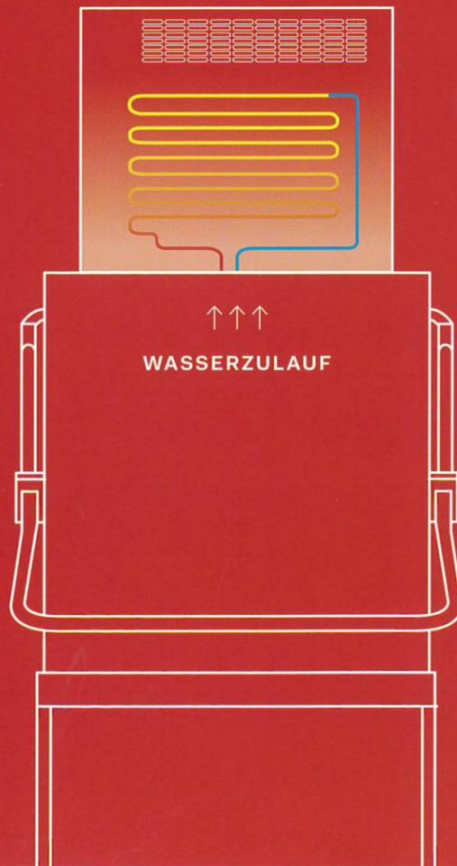
Diese Systeme sorgen für die Minimierung des Dampfaustritts, **um eine angenehmere Arbeitsumgebung zu schaffen** und gleichzeitig die Wärme des Gerätes zur Unterstützung der Erwärmung des Zulaufwassers zu nutzen sowie eine Reduzierung der Energiekosten zu erzielen. Diese Reduzierung des Dampfes in der Spülkammer trägt außerdem zu einer schnelleren Trocknung von Gläsern und Geschirr bei.
